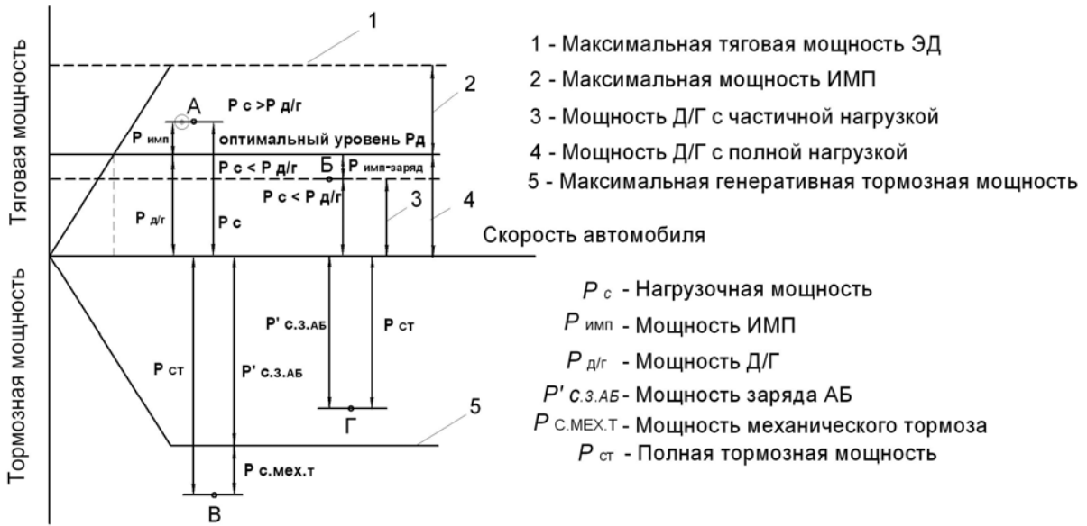
Рис. 3.6. Стратегия мобилизации максимального уровня заряда источника пиковой мощности:
