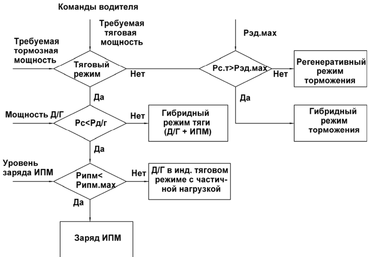
Рис. 3.7. Схема алгоритма управления стратегии стабилизации максимального уровня пиковой мощности.
